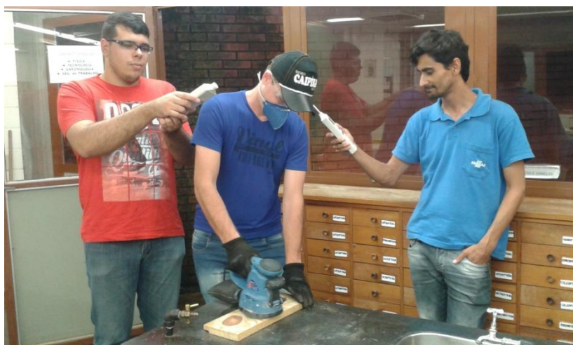
Alunos realizando a aferição do nível de pressão sonora em operador de lixadeira
