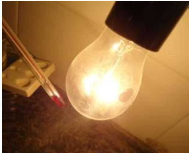
Utilização do termômetro de mercúrio para averiguação da temperatura na lâmpada incandescente
