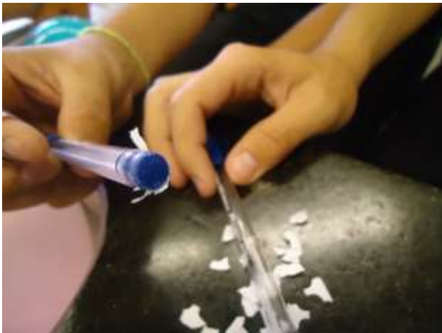
Eletrização por atrito sendo demonstrada no tubo de caneta e no balão de bexiga com pedaços de papel
