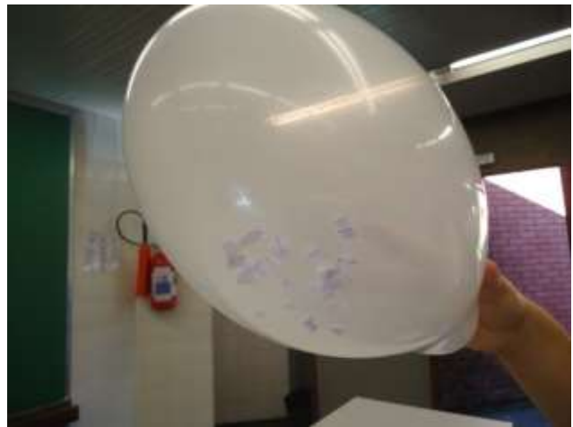
Eletrização por atrito sendo demonstrada no tubo de caneta e no balão de bexiga com pedaços de papel
