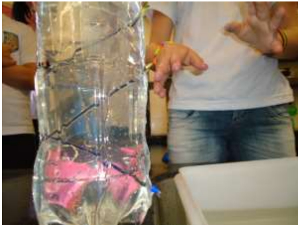
Experimento sobre hidrostática: demonstra a pressão hidrostática da água
