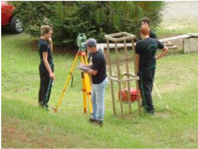
Alunos fazendo a medição de terrenos para diagnosticar tamanhos e limites
