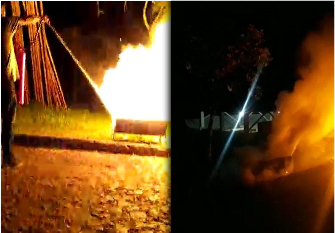
Parte prática sobre o uso correto de extintores, sendo: à esquerda, explosão causada pelo uso incorreto de extintor tipo A em incêndio tipo B; à direita, incêndio controlado graças ao uso correto do extintor tipo ABC em incêndio tipo B.
