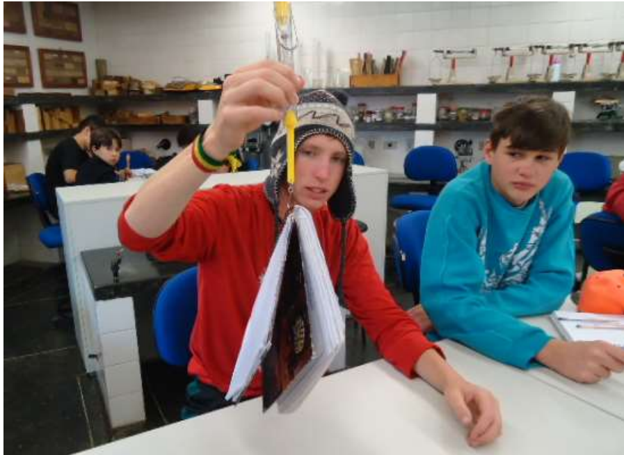
Aluno utilizando um dinamômetro para medir a força-peso exercida pelo caderno
