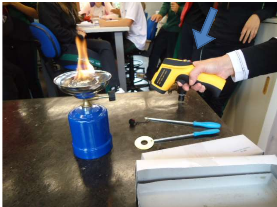
Utilização de um termômetro de infravermelho para medir a temperatura do fogo
