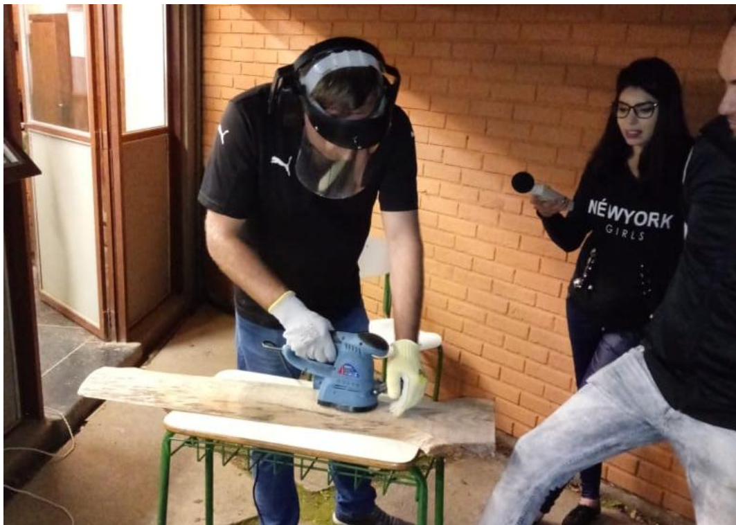
Medição do ruído de uma lixadeira com decibelímetro
