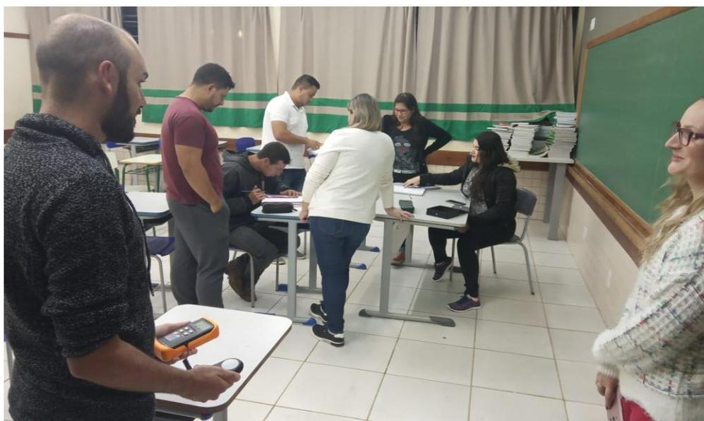
*Medição efetiva dos pontos previamente instalados em sala para posterior cálculo da iluminação média*
