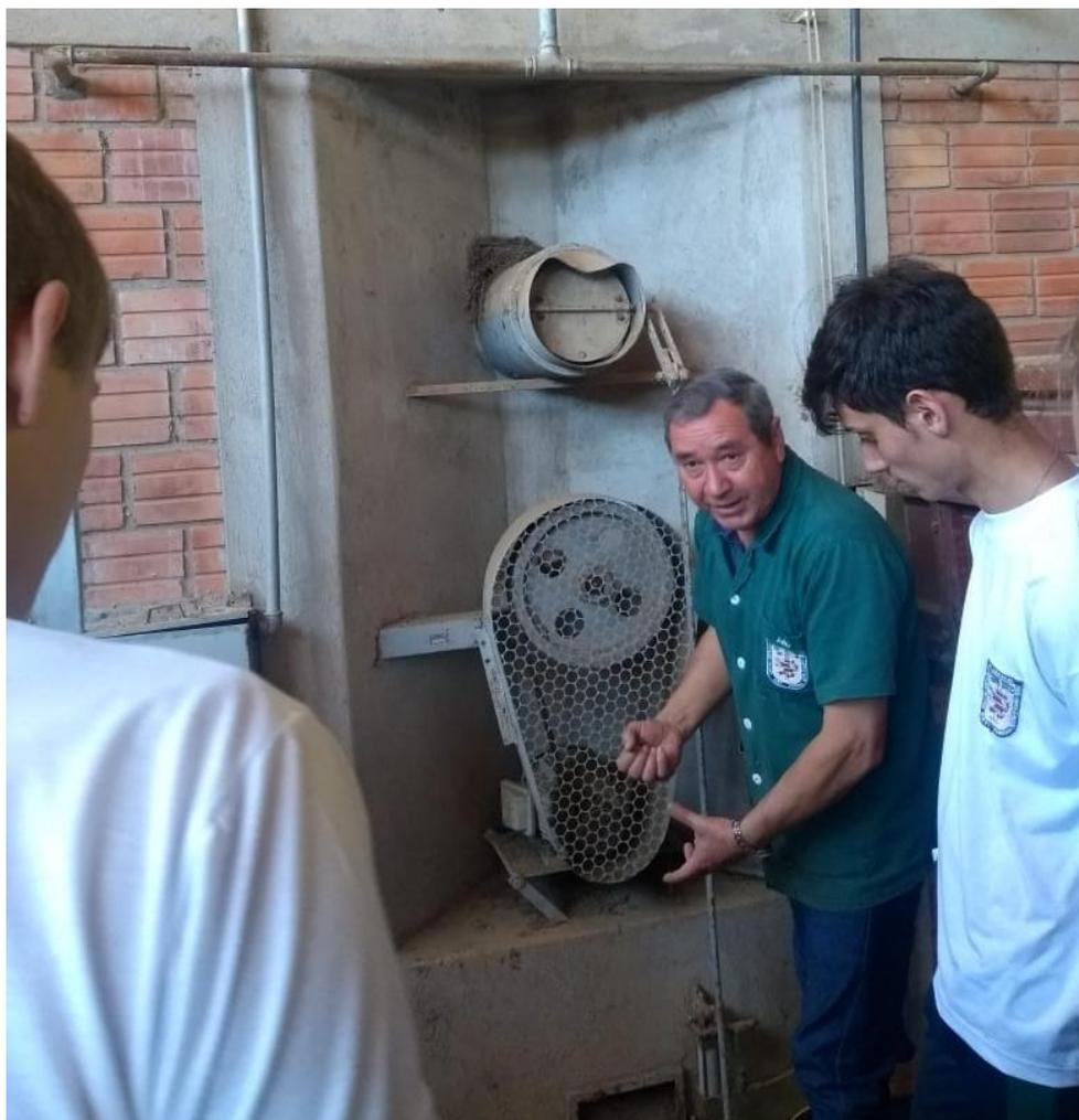
*Sistemas de controle de entrada e saída de ar na estufa visando uma secagem uniforme da madeira*
